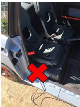
Le câble n'étant pas monté sur enrouleur, merci de le repousser dans son logement avant de prendre la route afin de ne pas l'endommager en fermant la portière.
